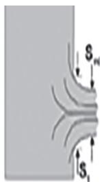
Figura 1. Vena contracta: características de un flujo al salir de un orificio.
